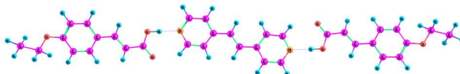
Рис.2. Н-комплекс, образованный пара -н-этилоксикоричной кислотой и бипиридиновым соединением с мостиковой группой \text{CH=CH} .
