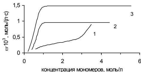
Рис. 1. Зависимость скорости полимеризации от текущей концентрации мономеров в реакционной массе. Начальная суммарная концентрация мономеров, моль/л: 1 – 3,81; 2 – 4,4; 3 – 5,55. t = 65^\circ\text{C} . Концентрация инициатора 5,95 \cdot 10^{-3} моль/л
