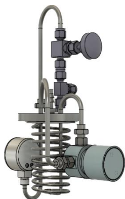
Рис. 6. Газопроводящие элементы конструкции
