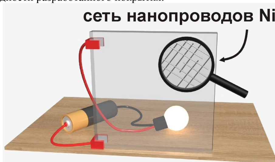
Рис. 1. Прозрачное покрытие на стекле, созданное на основе ориентированных наносетей никеля и его субмикронных волокон (иллюстрация концепции).
