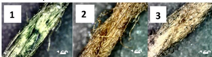
Рис.1. Микроскопические фотографии хлопковых волокон, обработанных полиамидом (С = 0,5 ммоль / л) и полиаминами: 1 - ПАНИ; 2 - ППФДА; 3 – ППТД
